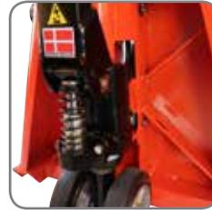
Una válvula de caudal especial garantiza un descenso controlado y un posicionamiento cuidadoso de la bobina.
